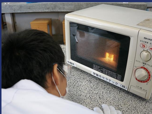
金属がスパークして加熱されている様子
