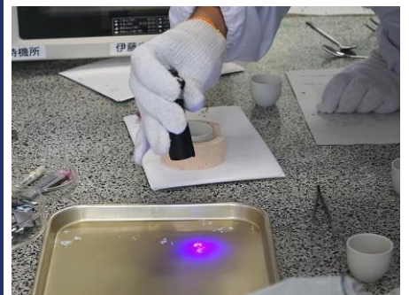
レンジ後、ルビーができたか確認のため、ブラックライトを照射
