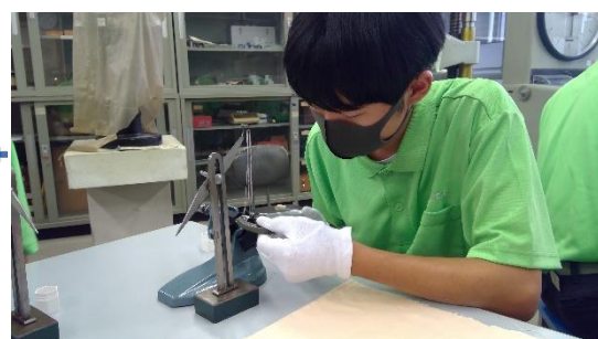
三針法によるねじプラグゲージの有効径測定
